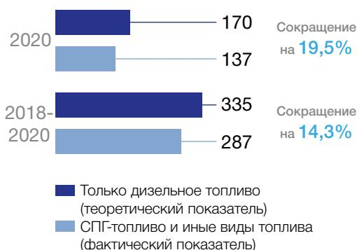
При условии работы танкера типа Aframax исключительно на СПГ-топливе снижение выбросов оксидов серы и сажи достигает 100 %, выбросы оксидов азота сокращаются как минимум на 76 %, а снижение выбросов углекислого газа может достигать 30 % по сравнению с судовой энергетической установкой, работающей на стандартном тяжелом топливе.
